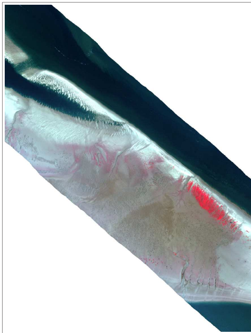
Figuur 3.26.: Hoge resolutie remote sensing beeld van het noordelijk gedeelte van de Plaat van Walsoorden in 1998 met details van de groei van het schor. De intens rode kleur op deze beelden toont de aanwezigheid van hoge concentraties chlorofyl.
