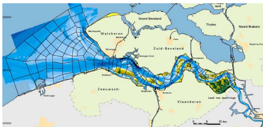
Figuur 3.4a: Estmorf schematisatie voor de Westerschelde.
