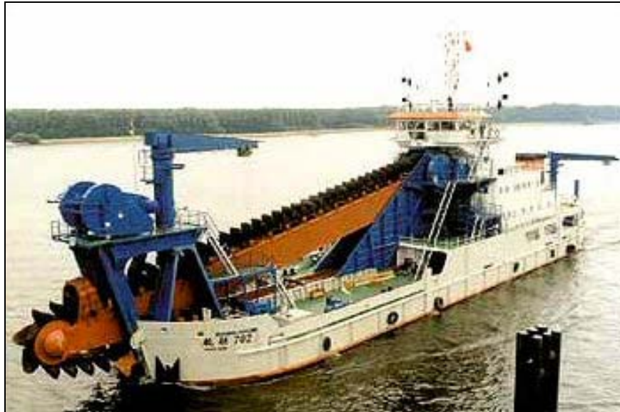
Figuur 5-2: Emmerbaggermolen met ladder
