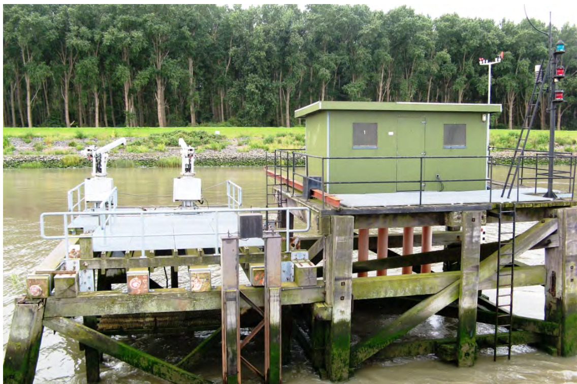
Figuur 99 - Beneden-Zeeschelde te Oosterweel: foto van de meetduk dalf met aan linkerkant (opwaartse zijde) de twee kranen elk dragend een Aanderaa-meettoestel en aan rechterkant (afwaartse zijde van de dukdalf) de meethut met tij- en meteo-meting
