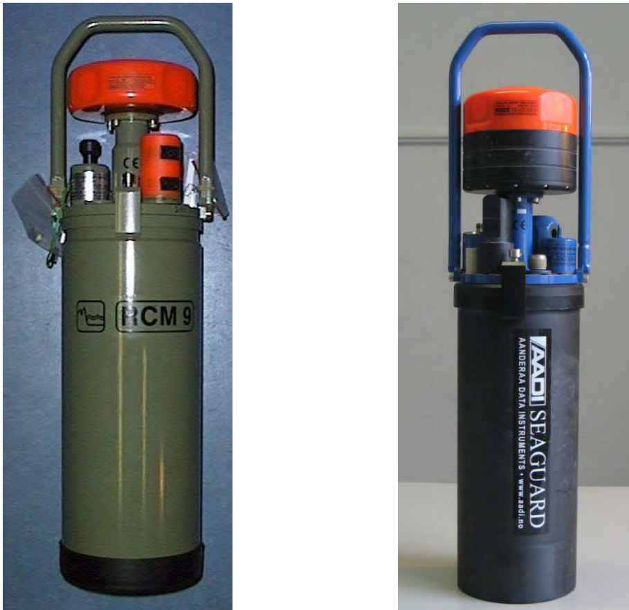
Figuur 92 - Aanderaa-multiparametertoestel (type RCM9 (links) en type Seaguard (rechts))
