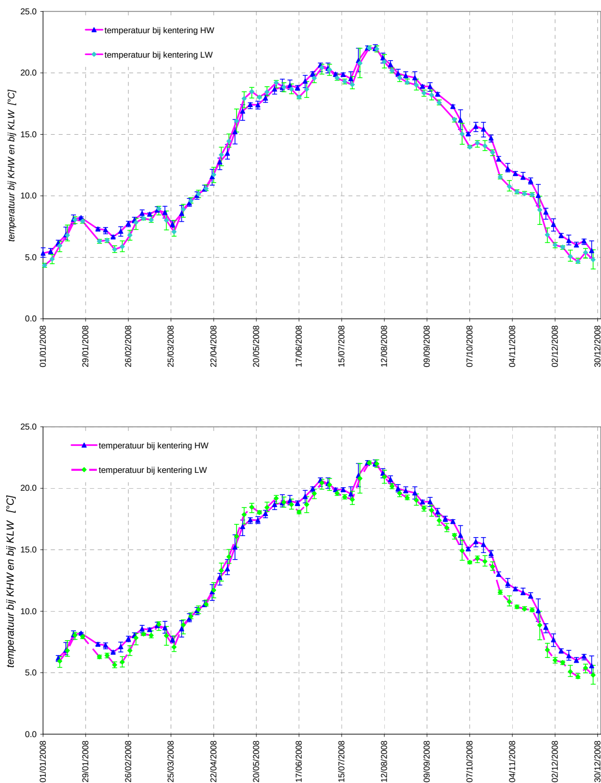
Figuur 76 - Beneden-Zeeschelde te Oosterweel : jaarverloop 2008 per vijfdaagse periode van de temperatuur bij KHW en bij KLW (bovenste figuur gaat over het bovenste meettoestel, onderste figuur over het onderste)
