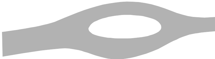
Figuur 0.6 Een macrocel bestaande uit een eb- en een vloedgeul met een plaat ertussen
