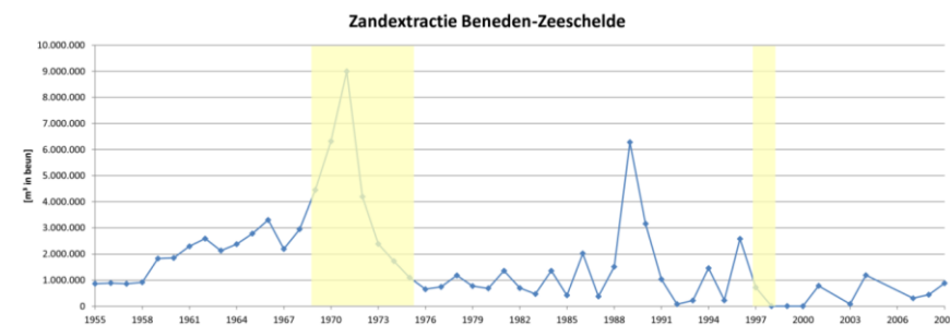
Figuur 7.11 Volume zand dat uit het systeem van de Beneden-Zeeschelde gehaald werd [ \text{m}^3 in beun]. De verdiepingsperiodes in geel (LTV V&T-rapport K-19).
