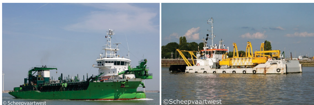
Figuur 1 – Sleehopperzuiger (links) en sweepbeam (rechts)
