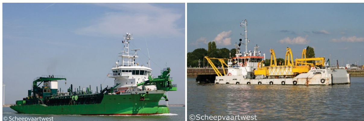
Figuur 1 – Sleephopperzuiger (links) en sweepbeam (rechts)
