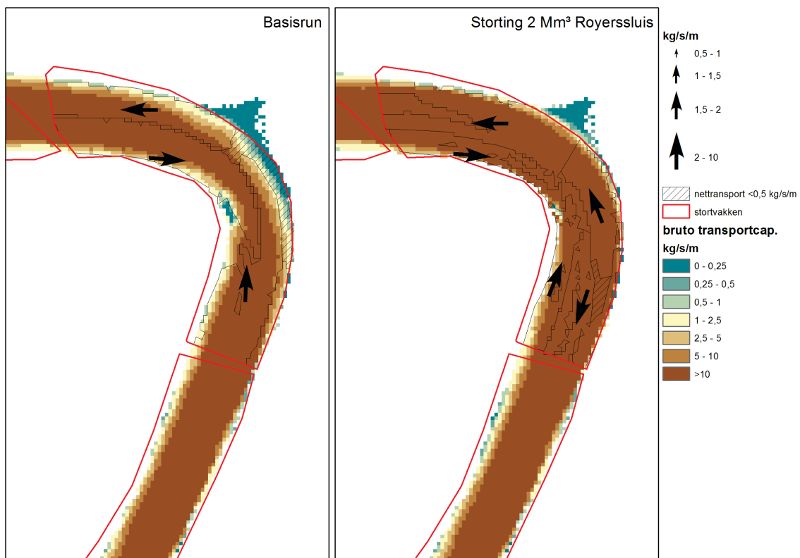
Figuur 19 – Vergelijking Bruto- en netto-transportcapaciteit voor en na de storting van 2 Mm 3 Royerssluis
