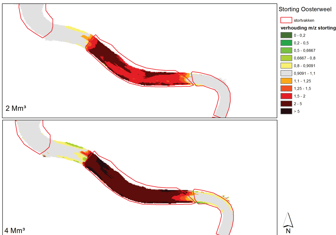
Figuur A 99 – Verhouding van de bruto sedimenttransportcapaciteit voor de storting en na de storting van 2 Mm 3 (links) en van 4 Mm 3 (rechts) ter hoogte van Oosterweel
