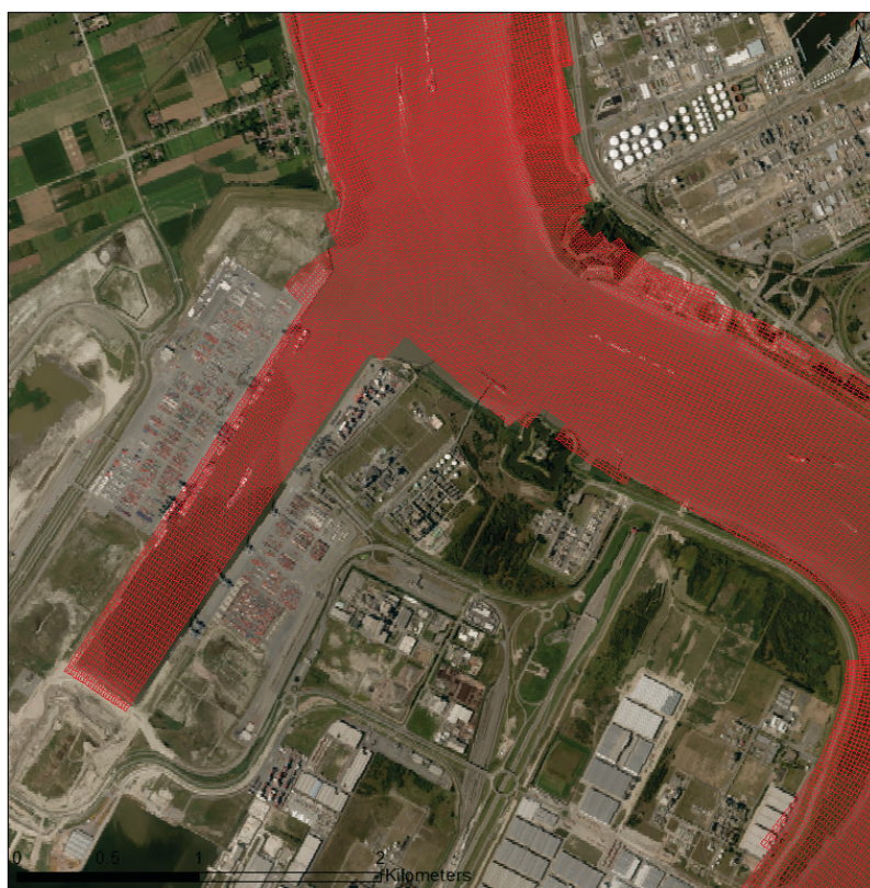
Figuur 4 – Modelgrid ter hoogte van Deurganckdok
